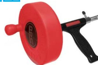
Tipo a molla in acciaio zincato speciale temprato, resistente alle abrasioni e corrosioni fino a 1960 N/mm². Robustissima costruzione a doppia spirale e doppio avvolgimento. Allungabili con prolunghe Art. 775 GD. Completo di manovella, presa salvamano, molla e testina a triplo gancio Art. 775 GE.
